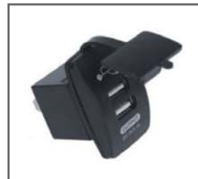
APC-T005 Size: 32*28mm Input:12-24V USB Output:5V 3.1A
